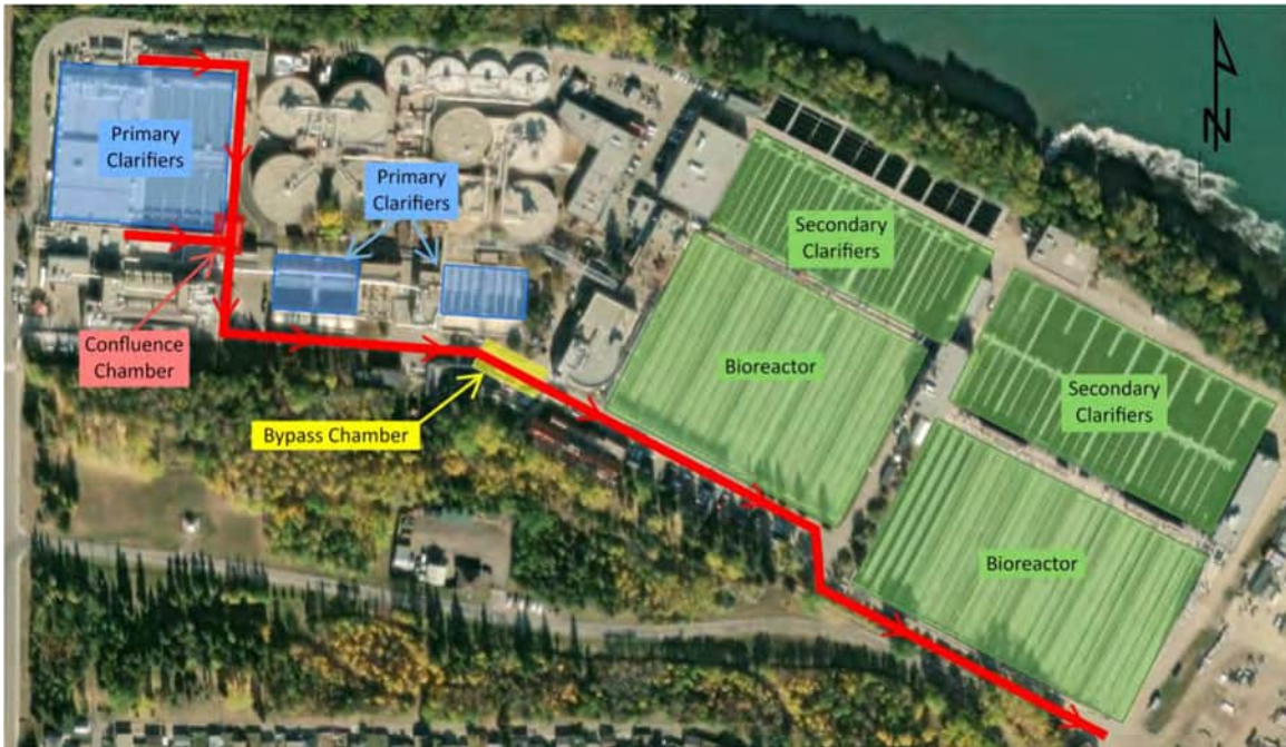
FIGURE 9 PE CHANNEL PATH
